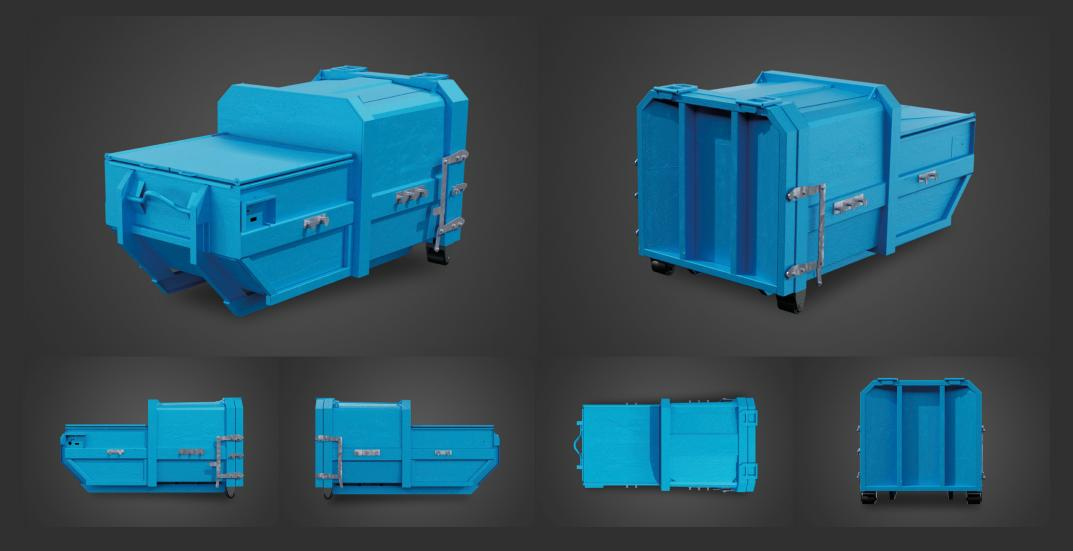
Der m5 unserer m-Serie ist ein qualitativ hochwertiger Presscontainer für Absetzer gem. DIN 30723 und DIN 30730. Die Ausstattung und Funktionalität eignen sich optimal zum Einsatz als Maschine in der Ringentsorgung (Einzel- & Rampenaufstellung). Die Konstruktion ist einer FEM-Berecnung zur Überprüfung auf max. Belastbarkeit unterzogen worden. Eine moderne SPS-Steuerung bis -20°C im Standard einsetzbar, ermöglicht einen rationellen und effizienten Einsatz an allen Entsorgungspunkten.
